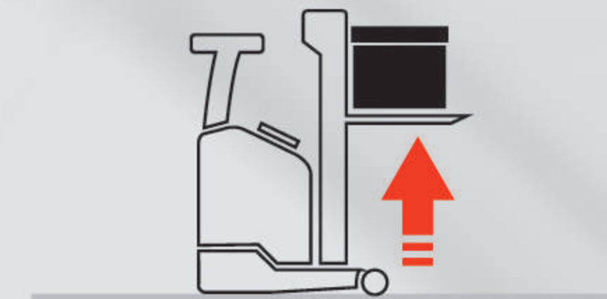
Vitesse de levage maximale avec charge 0,4 m/s
