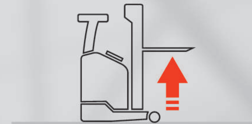
Vitesse de levage maximale sans charge 0,6m/s
