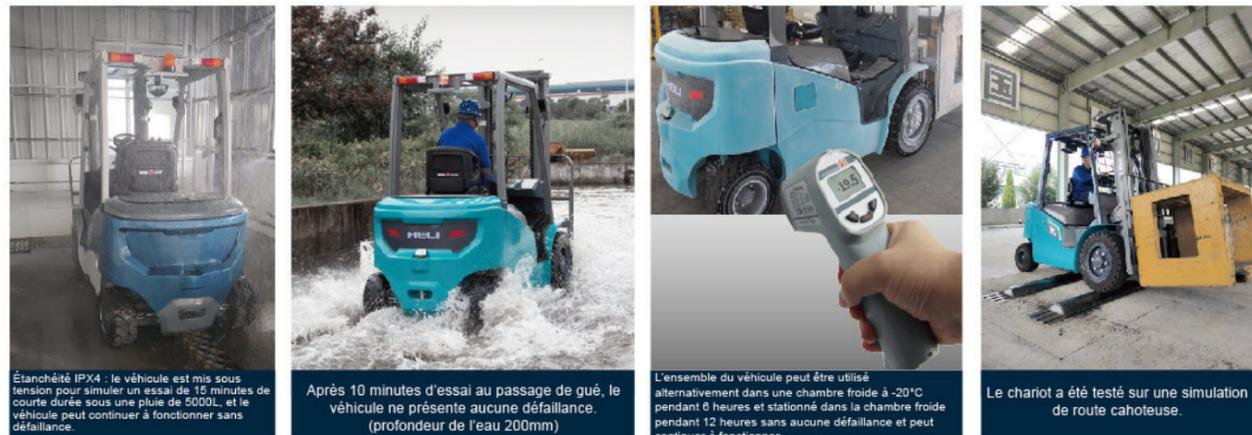
Étanchéité IPX4 : le véhicule est mis sous tension pour simuler un essai de 15 minutes de courte durée sous une pluie de 5000L, et le véhicule peut continuer à fonctionner sans défaillance.
